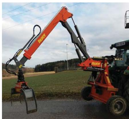
Dies ist ein universelles Gerät auf der Traktorhydraulik und kann wie eine Rückezange für Schwachholz und Wied eingesetzt werden, als auch für stärkeres Holz zum Rücken und Verladen. Für den Einsatz mit kleineren Traktoren ab etwa 60-70 PS ist dieser Kran auch mit Rädern ausgestattet. Die Reichweite beträgt fünf Meter. Das Gerät verfügt über eine eigene Hydraulikversorgung. Kontaktperson: Thaller Johann
