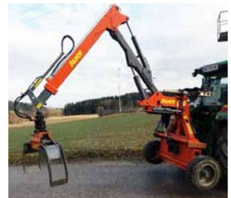
Dies ist ein universelles Gerät auf der Traktorhydraulik und kann wie eine Rückezange für Schwachholz und Wied eingesetzt werden, als auch für stärkeres Holz zum Rücken und Verladen. Für den Einsatz mit kleineren Traktoren ab etwa 60-70 PS ist dieser Kran auch mit Rädern ausgestattet. Die Reichweite beträgt fünf Meter. Das Gerät verfügt über eine eigene Hydraulikversorgung.
